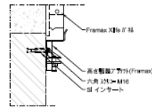
高さ調整アジャスター (Frameax) 詳細図 図 110
