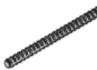
許容荷重、安全率 1.6 の場合: 120 kN<br>許容荷重、DIN 18216 を基準: 90 kN<br>破壊荷重: 195 kN<br>タイロッドの溶接???加熱は厳禁 - 破壊の危険性が生じる |      |
